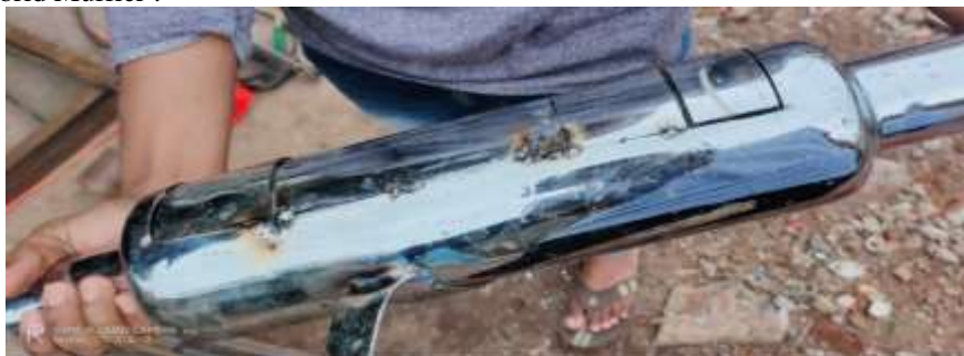
Fig.15. Final Hybrid Muffler.
