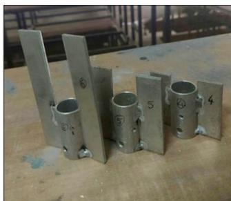
**Fig 6 : Attachable rectangular 2 fins**
