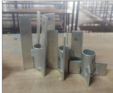
**Fig 8 : Attachable rectangular 4 fins**
