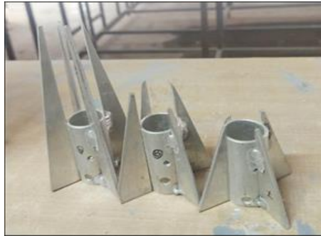
Fig 7 : Attachable rectangular 4 fins
