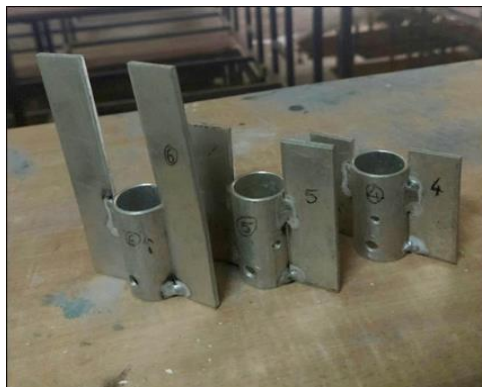
Fig 5 : Attachable rectangular 2 fins
