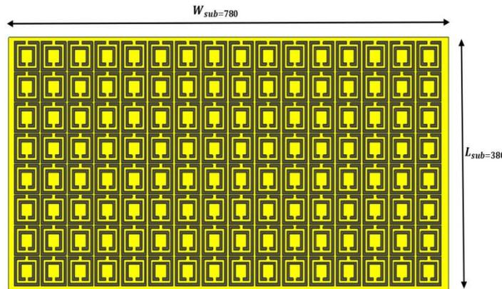
Fig.11. 128 Elements of CSSR Metasurface
