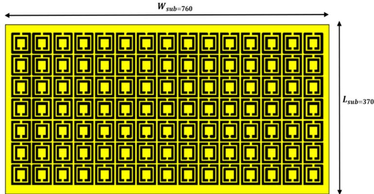
Fig.10. 105 Elements of CSSR Metasurface
